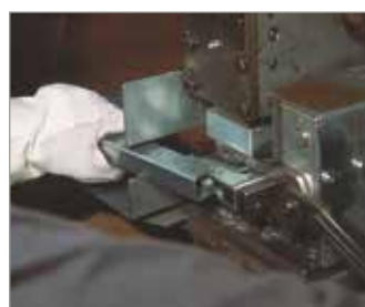
Sie kennen das Wort „clinch“ wahrscheinlich aus dem Boxsport. In der MANUFLEX-Fertigung werden Regalstreben und Knotenwinkel zu einem Strebenelement verclinchet. Dies ist die Basis für die Regalrahmen STANDARD und BUDGET
