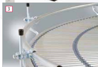
3 Seitenführungen Aus Stahlrohr 25 mm Ø verzinkt. Stufenlos höhen- verstellbar von 50–130 mm. Breite stufenlos ver- stellbar von Bahn-Nutbreite -140 bis +24 mm.
