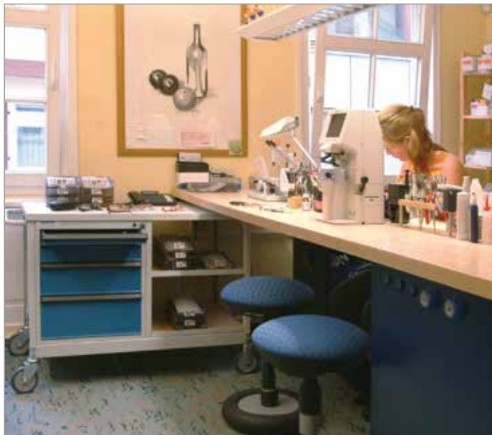
Mobiler Werkstattwagen mit Abdeckplatte Melamin lichtgrau 22 mm
