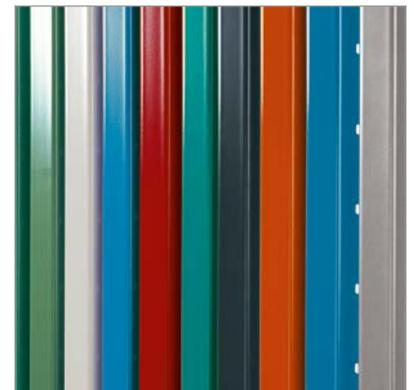
Die langlebigen Rahmen des Regalsystems PLANAFIX erhalten zuerst eine Eisenphosphatierung. Anschließend wird bei 180 Grad eine Pulverbeschichtung eingebrannt. So erhält der Rahmen eine widerstandsfähige und korrosionsfreie Oberflächenqualität.
