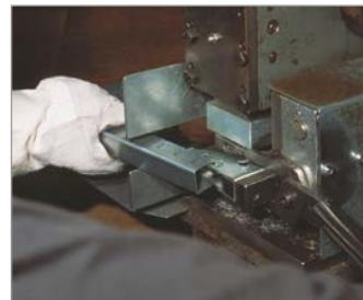
Sie kennen das Wort „clinch“ wahrscheinlich aus dem Boxsport. In der MANUFLEX-Fertigung werden Regalstreben und Knotenwinkel zu einem Strebenelement verclinchet. Dies ist die Basis für die Regalrahmen STANDARD und BUDGET
