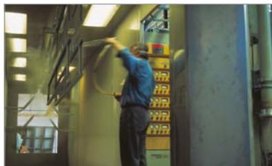
Die langlebigen Rahmen des Regalsystems PLANAFIX erhalten zuerst eine Eisenphosphatierung. Anschließend wird bei 180 Grad eine Pulverbeschichtung eingebracht. So erhält der Rahmen eine widerstandsfähige und korrosionsfreie Oberflächenqualität.
