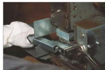
Sie kennen das Wort „clinch“ wahrscheinlich aus dem Boxsport. In der MANUFLEX-Fertigung werden Regalstreben und Knotenwinkel zu einem Strebenelement als Basis für die Regalrahmen STANDARD und BUDGET umklammert und „verclinch“.
